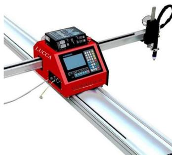
Lucca es una máquina de corte CNC que tiene como método de corte Plasma y Oxicorte con capacidad de corte de 1800 x 3000mm Puede ser programado mediante el software que trae incorporado FastCam con cuatro módulos de dibujo. Fácil de operar, portátil y ligera.
