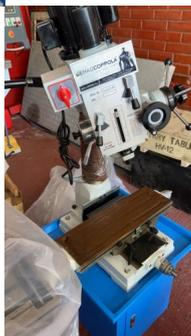
Taladro Fresador con un tamaño de mesa 500x140mm, con cabezal engranado.
