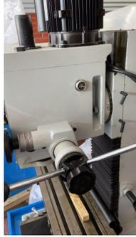
Taladro Fresador con Mesa Universal, disponible en dos versiones, máquina equipada con lector de coordenadas y sin lector de coordenadas. Características: Columnas prismática con guías de cola milano, dimensión de la mesa 1000x240mm, cabezal engranado en 90°.
